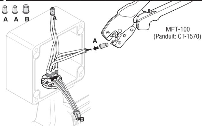
使用压接工具MFT-100安装压接。
